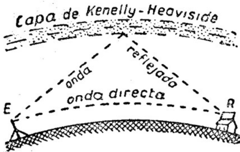
Figura 102. — La onda del trasmisor llega a la antena de recepción R por dos caminos distintos: siguiendo la superficie de la tierra y por reflexión de las altas capas de la atmósfera.
